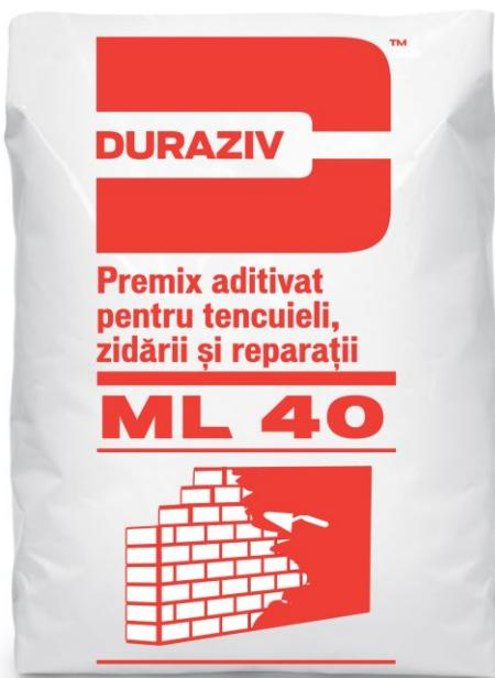
Pentru prepararea de mortare economice, premixul se introduce împreună cu nisipul corespunzător clasei de mortar dorită, într-o betonieră de capacitate corespunzătoare, se adaugă apă curată la temperatură obișnuită și se amestecă mixtura cel puțin trei minute. Pentru reparații, premixul se amestecă cu apă în proporție de 5 părți premix la 1 parte apă, rezultând un mortar fin cu care se pot umple cavități și denivelări de până la 1 cm.
